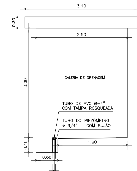
DETALHE - 01 SEÇÃO DA GALERIA (NÍVEL - 01) ESCALA - 1/50
